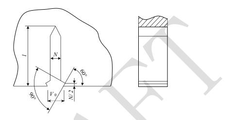
$V_0$ : knife edge spacing
